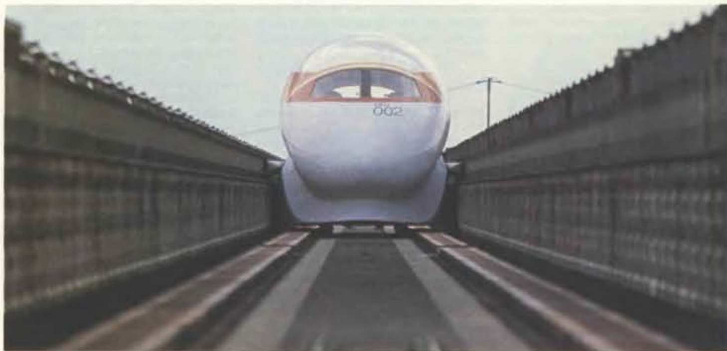
ПОЕЗД НА МАГНИТНОЙ ПОДУШКЕ на испытательной установке в Японии. Фото Т. Мацумото/Syigma.
