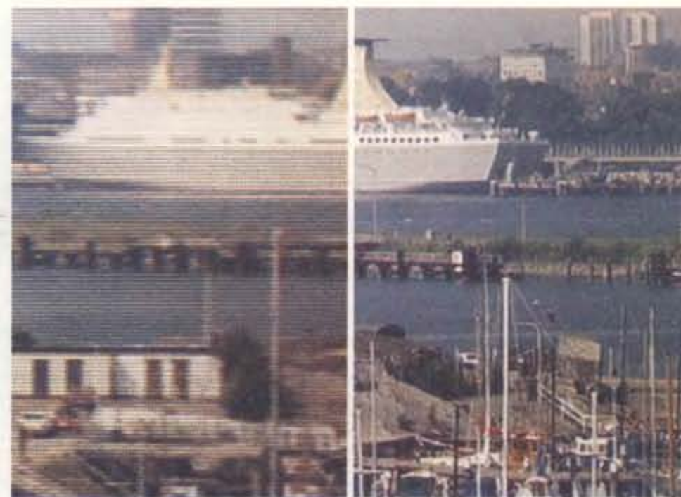
УДВОЕНИЕ ЧИСЛА СТРОК традиционного телевизионного изображения (слева) — с 625 до 1250 — основное условие получения изображений высокой четкости (справа).
