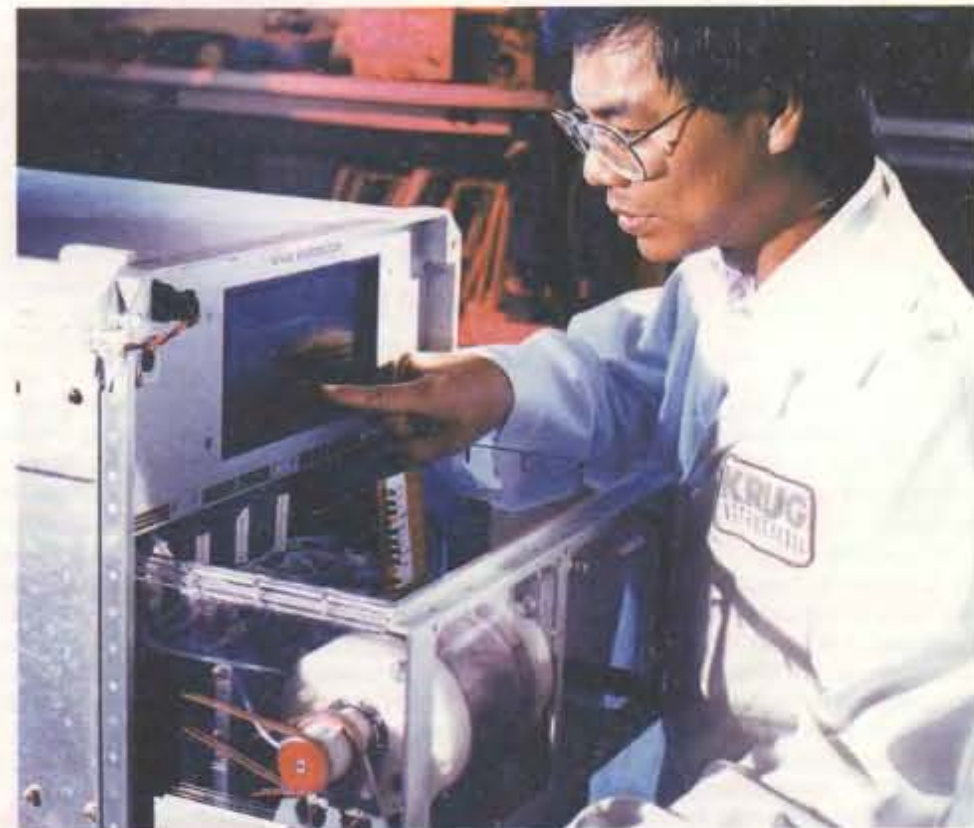
ВРАЩАЮЩИЙСЯ РЕАКТОР ДЛЯ КУЛЬТИВИРОВАНИЯ КЛЕТОК, разработанный в НАСА, позволяет клеткам дифференцироваться больше, чем в обычных культурах. (Фотография: NASA Johnson Space Center.)
